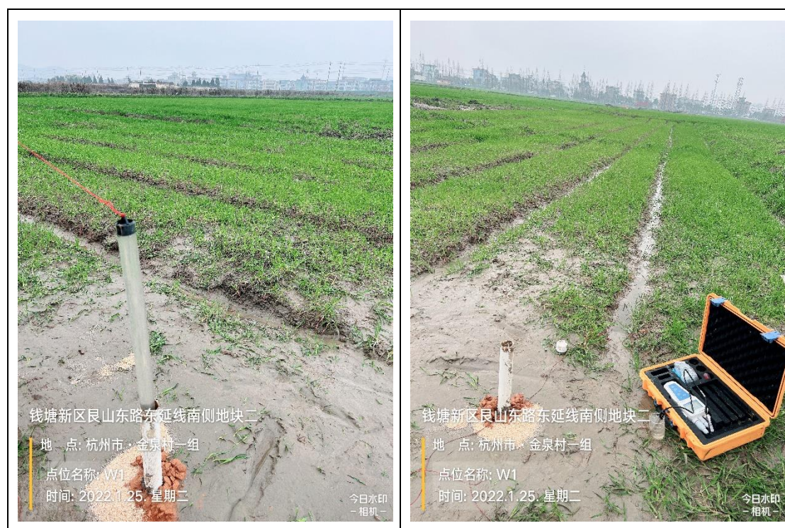
图 5.2-7 地下水洗井照片
