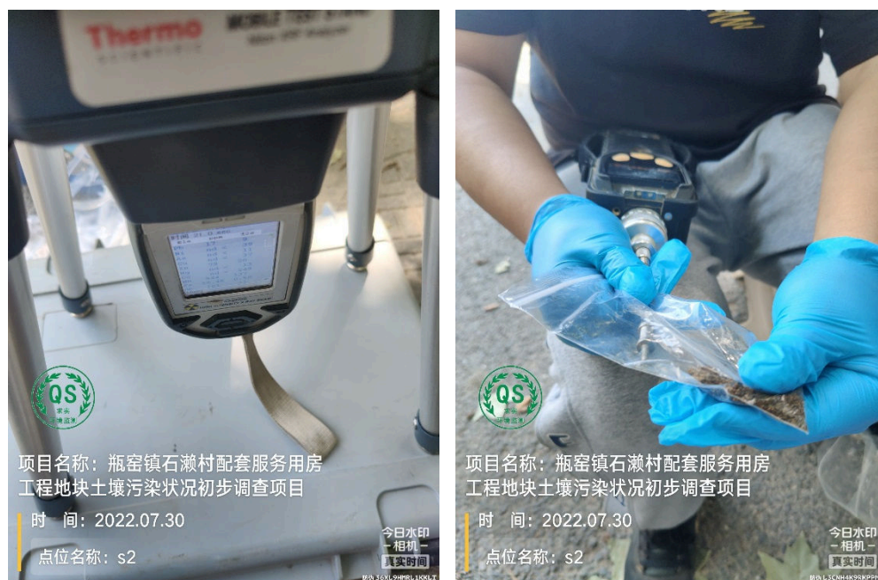
图 5-5 XRF、PID 现场照片
