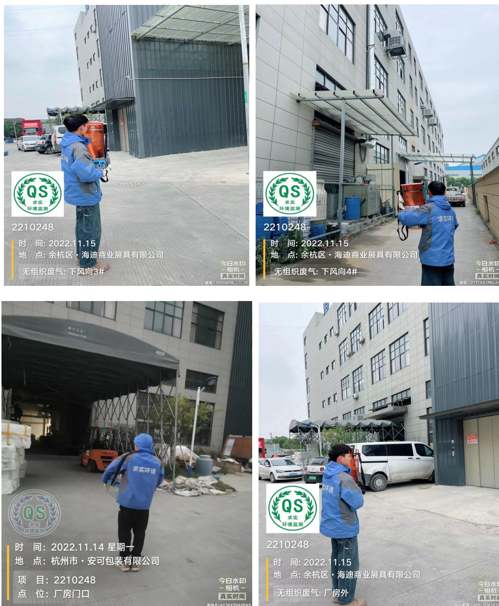
图 7-3 无组织废气监测内容及现场采样照片
