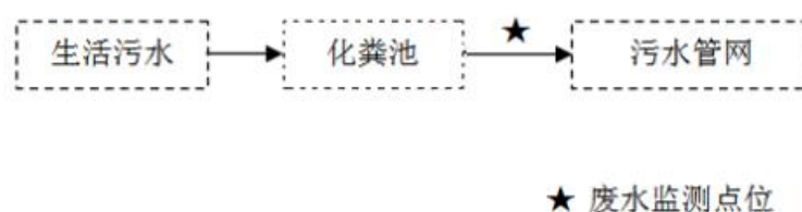
图 4-1 全厂废水流向及监测点位图
