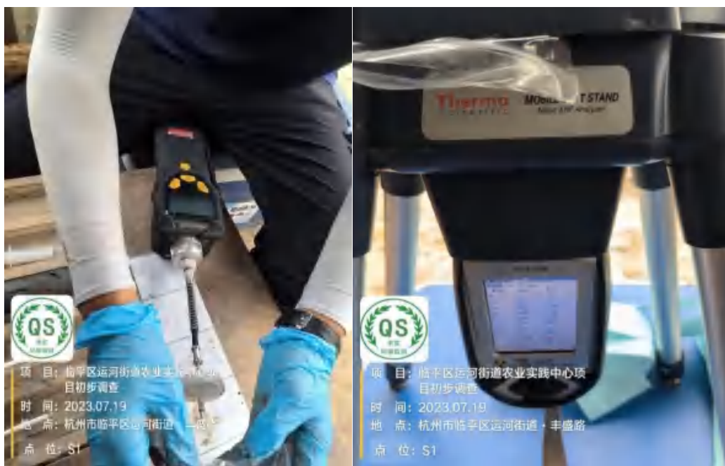
图 6.3-1 土壤 PID、XRF 快检图
