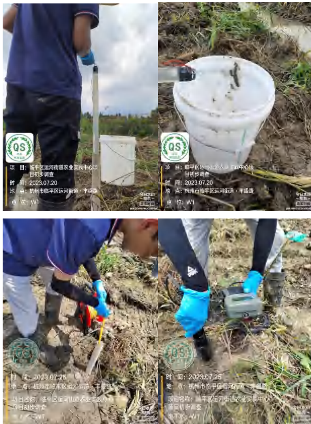
图 6.1-5 地下水井成井洗井、采样前洗井图
