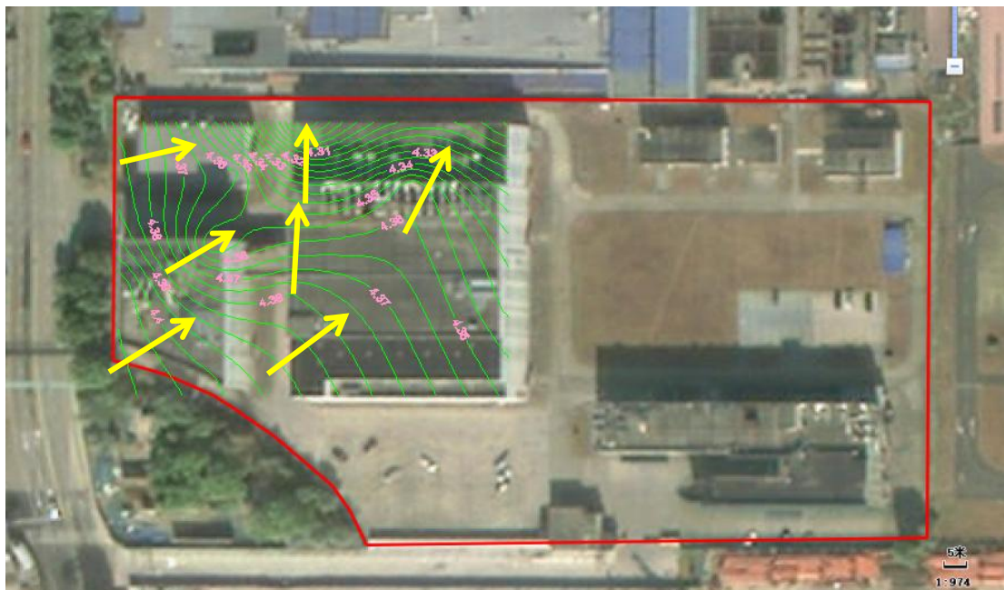
图 3.2-2 地下水等高线及地下水流向图
